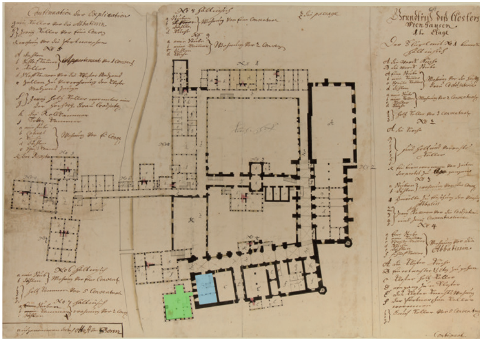
Abb. 5: Klostergrundriss mit der alten Küche im Westflügel (blau) und dem bis 1957 existierenden neuen Küchenbau (grün; OTTO VON BONN: Grundriß deß Closters Winhausen. A Erdgeschoss, 1723; Wienhausen, Klosterarchiv, Bz-1-a).
